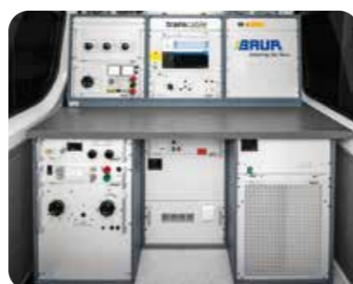
↑ 04 / transcable cable test van
